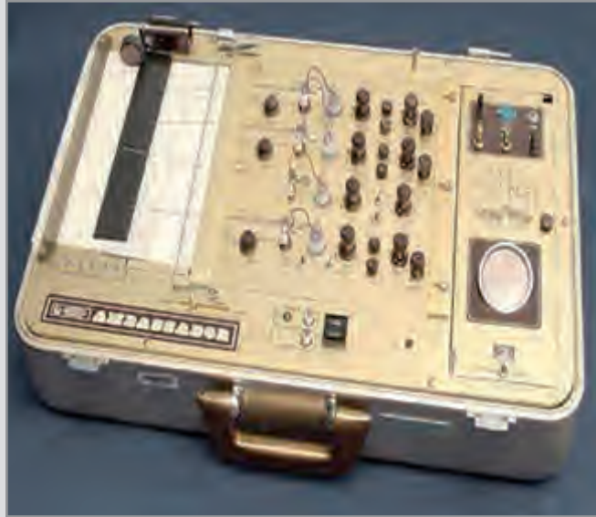
جهاز البولي غراف، وهو جهاز يقيس سرعة النبض وكمية التعرق ونسبة التنفس وضغط الدم، وقد لاحظ العلماء أن هذه النسب تتغير أثناء الكذب ولكن هذا الجهاز غير دقيق لأن الكاذب المحترف يستطيع التغلب على هذه التغيرات
