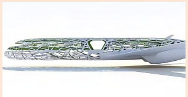
شكل ١: التركيب الداخلي لطائرة إيرباص المزمع صنعها في المستقبل مستفيدة من هيكل العظمي للطيور.
